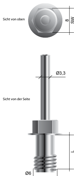
Abb. Nietbolzen – Ausführung und Abmessungen (in mm)
