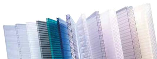
**Makrolon® multi UV 5M/32-20** ist eine Stegplatte aus Polycarbonat mit einer Dicke von 32 mm und einer M-Struktur, die für höhere Steifigkeit sorgt. Sie vereint gute Lastabtragung und hervorragende Wärmedämmung mit Lichtdurchlässigkeit und ausgezeichneter Witterungsbeständigkeit. Die Platte ist leicht, schlagzäh und einfach zu verlegen.
