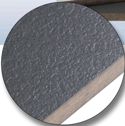
**MPB** sind preiswerte, hochverdichtete **HPL-Kompaktplatten** (HPL = High Pressure Laminates). Sie sind besonders für DIY-Anwendungen im Innenbereich und für nicht-tragende Anwendungen geeignet.
